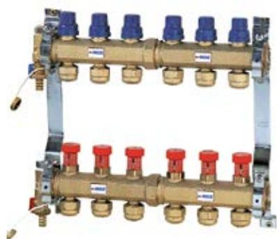
Collettori serie Control Ø 1¼" in ottone per la distribuzione dei tubi nei locali, completi di valvole di intercettazione (predisposte per la testina elettrotermica), detentori micrometrici con individuazione dei locali, gruppi di sfiato e scarico impianto a sfera con portagomma e tappi, staffe disassate con gommini antivibranti per inserimento in armadietto o fissaggio a muro, raccordi per il tubo in polietilene Ø 14, 17 o 20 mm.
