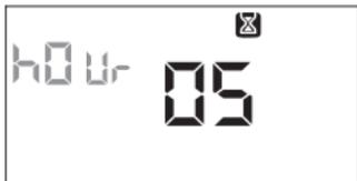
5. Una volta impostati tutti i parametri, per uscire e tornare al menù di programmazione, premere brevemente il tasto **SET**.
