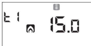
3. Viene visualizzato il valore della temperatura T1 lampeggiante. Modificare il valore con i tasti ▲ e ▼ e premere il tasto ⏏ per passare alla modifica di T2.
