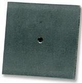
**LE DUE PLACCHE METALLICHE ALLEGATE DEVONO ESSERE USATE PER FISSARE ENTRAMBI I SENSORI A TERRA E PER GARANTIRE L'IMPERMEABILITÀ DEI SENSORI NEL FORO DI MONTAGGIO. SE PER MOTIVI COSTRUTTIVI LE PLACCHE METALLICHE NON POSSONO ESSERE IMPIEGATE, DEVE ESSERE APPLICATA UNA RONDELLA PIANA CON DADO. QUESTA È L'UNICA MISURA CHE POSSA ASSICURARE UNA SOLUZIONE IMPERMEABILE (GUARNIZIONE) AL FORO DELLA VITE.**
