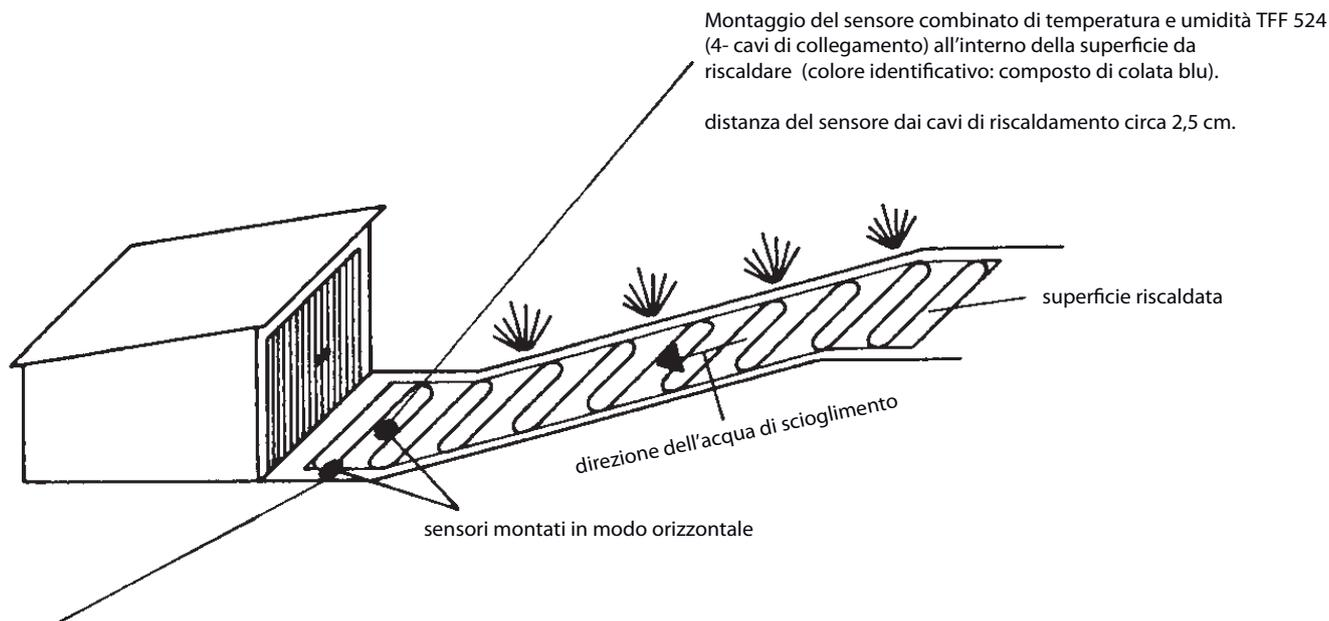
Montaggio del sensore per il ghiaccio e la neve ESF 524 (5- cavi di collegamento, colore identificativo: composto di colata giallo) min. 20 cm dalla superficie da riscaldare.
