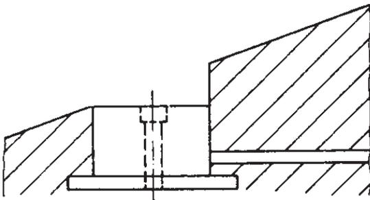
Il sensore deve essere montato orizzontalmente anche in caso di superficie in pendenza
