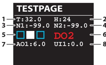
Attraverso questa schermata è possibile eseguire dei test di funzionamento sui relè (K1-K2-K3) e sull'uscita analogica (AnOut1)
