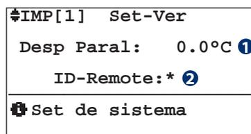
Entrando en la sub-pantalla de set sistema se puede ajustar, según la estacionalidad de funcionamiento el parámetro de sistema "Desplazamiento paralelo".
