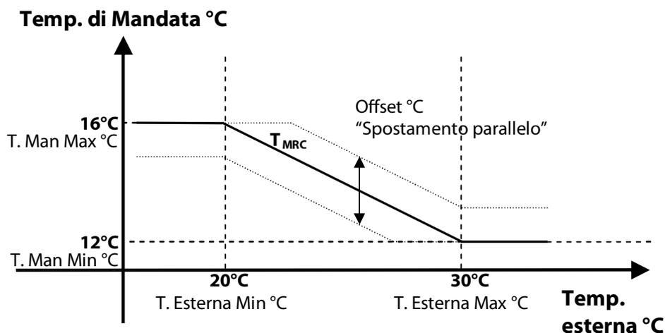
$T_{MRC}$  = Temperatura Calcolata tramite retta di compensazione
