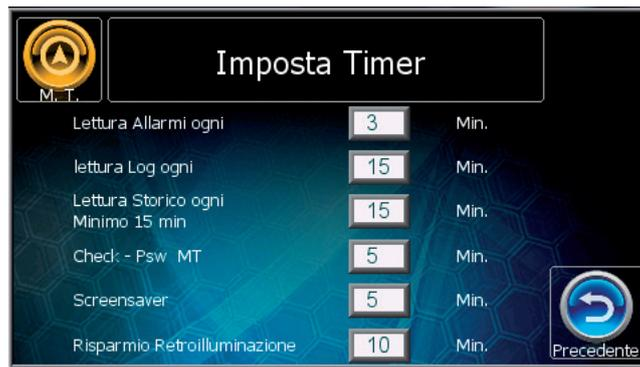
In questa maschera vengono impostati i timer di funzionamento del dispositivo.
