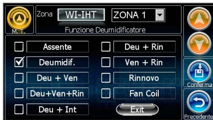
Se l'impianto prevede la gestione estiva è necessaria la configurazione del deumidificatore, e di conseguenza la configurazione nella fase 4) configurazione Zone della sonda TA/H che lo pilota.
