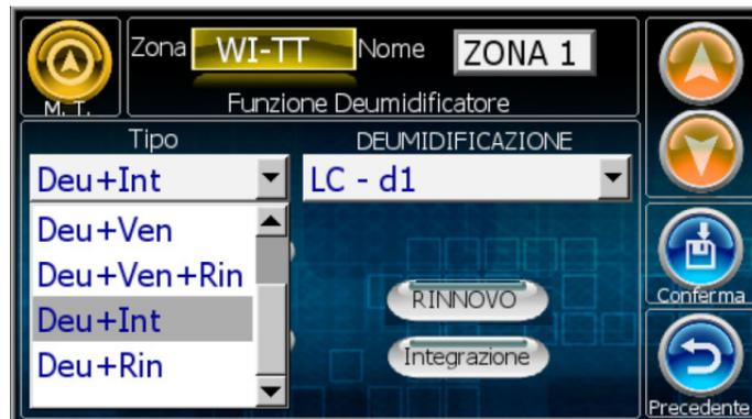
Se l'impianto prevede la gestione estiva è necessaria la configurazione del deumidificatore, e di conseguenza la configurazione nella fase 4) configurazione Zone della sonda TA/H che lo pilota.
