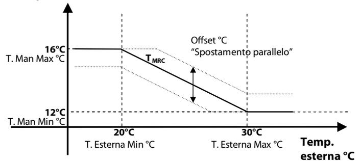
$T_{MRC}$  = Temperatura Calcolata tramite retta di compensazione
