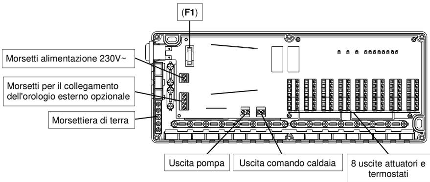
Fig. 3: Vista interna componenti.
