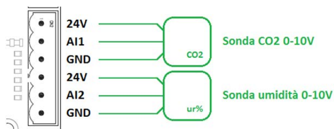
Figura 4 – Collegamento sonde umidità e qualità aria 0-10V
