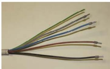
**Verificare la lunghezza delle prolunghe di alimentazione macchina. Una prolunga non adeguata nella sezione (2.5 mmq) può provocare una caduta di tensione e non garantire un corretto funzionamento delle apparecchia-**
