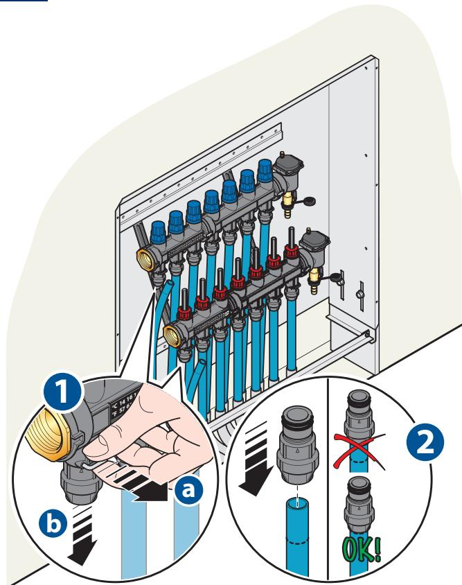
INSTALLAZIONE ALTERNATIVA DEL TUBO NEI RACCORDI
