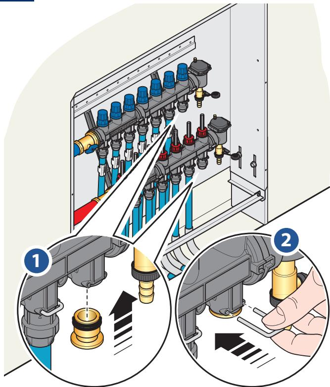
INSTALACIÓN ALTERNATIVA DEL TUBO EN LOS RACORES
