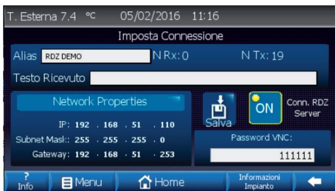
In questa Maschera è possibile impostare i parametri di rete e di collegamento remoto del dispositivo. Impostando l'indirizzo IP, la Subnet Mask, il Gateway della porta ethernet integrata e attivando la connessione al Server RDZ è possibile raggiungere il WI-TP remotamente.
