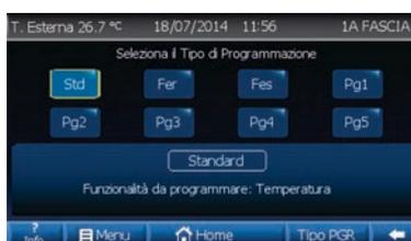
Permette di cambiare il tipo di programmazione per cui si sta impostando la fascia oraria. Impostabile per le funzionalità: Temperatura/ Deumidificazione/ Ventilazione/Rinnovo
