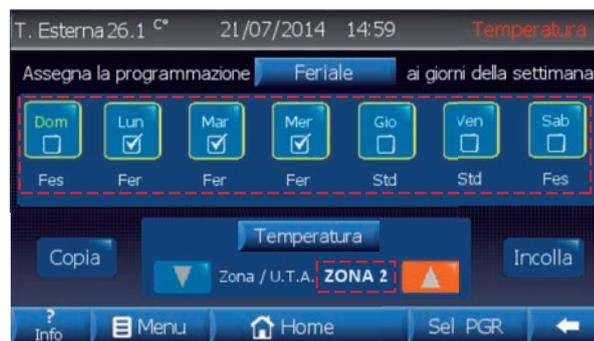
Ripetendo i passi sopra ripostati è possibile impostare la programmazione per tutte le funzionalità (TEMPERATURA, DEUMIDIFICAZIONE, VENTILAZIONE E RINNOVO) per tutti i giorni della settimana.
