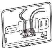
② Fissare la base a muro utilizzando le viti in dotazione.
