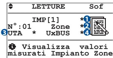
Tramite la sezione Letture possiamo accedere alle visualizzazioni dei dati fondamentali di funzionamento dell'IMPIANTO e delle ZONE.
