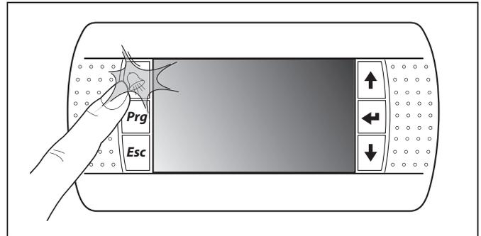
**NB: Se il problema viene risolto, quando si riaccende alle maschere di allarme l'errore non viene più indicato. Se nella centralina tutto funziona correttamente, premendo il tasto "Allarme" viene visualizzata la maschera in cui si fa presente che non è presente nessun allarme.**
