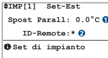
Entrando nella sottomaschera di set impianto si può impostare, a seconda della stagionalità di funzionamento il parametro di impianto "Spostamento parallelo".
