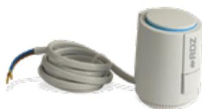
Testina elettrotermica per comando del singolo circuito tramite termostato ambiente. Può essere installata anche capovolta. Visualizzazione dello stato di funzionamento (aperta/chiusa), facilità di montaggio grazie al sistema di aggancio rapido tramite adattatore (compreso). Funzionamento: 230V con e senza micro di fine corsa e 24V con micro di fine corsa. Grado di protezione IP54 (in tutte le posizioni). Utilizzabile con i collettori: bklimax - Top Composit - Control e KIT alta temperatura.
