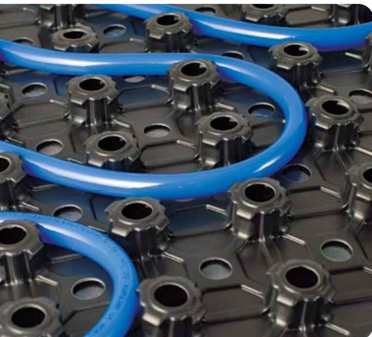
QUOTA ZERO AD è un sistema di riscaldamento e raffreddamento a pavimento a bassa inerzia termica e bassissimo spessore, composto da una tubazione in PB Ø 12 mm ancorata a una lastra termoformata priva di isolamento termico e annegata nel massetto autolivellante.
