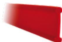
Giunto di dilatazione con base adesiva prodotto in polietilene espanso. Ottimale per il posizionamento sulle porte o quando si deve interrompere un massetto per garantirne la dilatazione. La parte superiore va rifilata a massetto ultimato.
