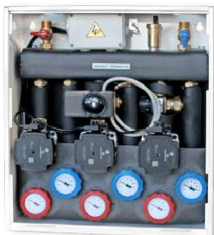
**MIXING BOX** è un dispositivo di termoregolazione per impianti radianti di **riscaldamento e raffrescamento** a pavimento. Si tratta in particolare di una sottostazione idraulica costituita da una serie di moduli che miscelano e rilanciano il fluido termovettore verso gli apparecchi emettitori tra i quali: sistemi radianti a pavimento, unità di deumidificazione, unità di trattamento aria, batterie idroniche di post trattamento.
