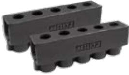
Coppia (A+R) gusci isolanti in polietilene espanso dotati di 5 uscite per parte centrale dei collettori CONTROL. Adatti all'installazione negli armadietti SLIM e nei Kit di termoregolazione. Temperature di utilizzo da -60 °C a 90 °C.
