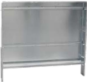
Armadietto da incasso SLIM per collettore TOP COMPOSIT e CONTROL, costruito in lamiera zincata, spessore 0.8 mm, piedini regolabili, altezza cm 70÷74, dotato di rete metallica sullo schienale, falsi fori per entrate laterali, guide per coppia staffe disassate, coperchio di protezione per intonaci.
