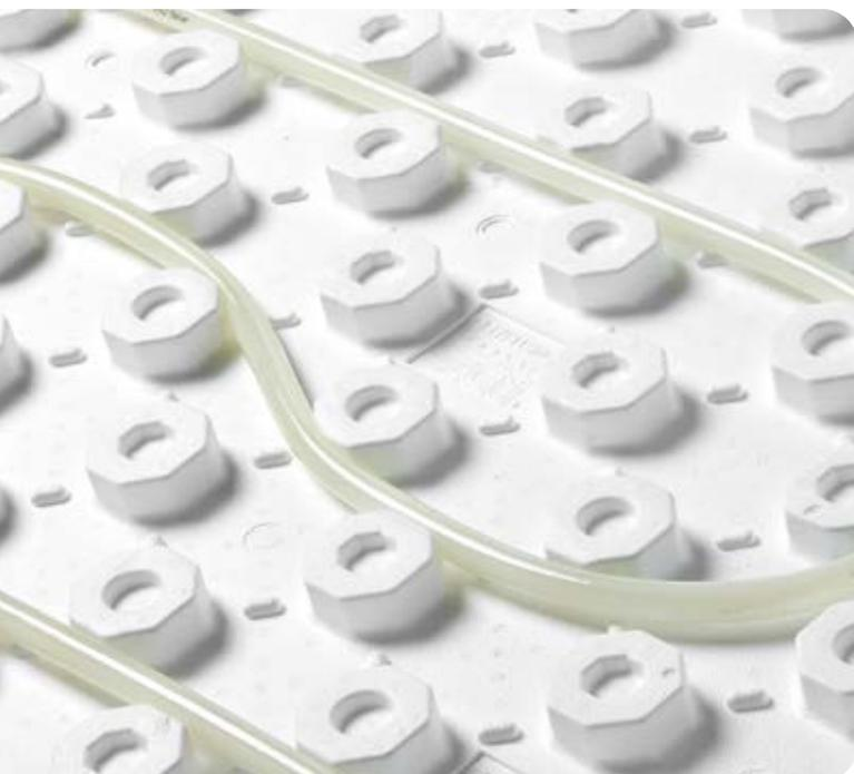
SAGOMATO INDUSTRIALE è un sistema di riscaldamento a pavimento a bassa temperatura caratterizzato da tubazione ancorata a una base isolante e annegata nel massetto. Si tratta di una soluzione ideale per beneficiare dei vantaggi di posa offerti da un sistema bugnato civile anche nel caso di capannoni industriali di grandi dimensioni.
