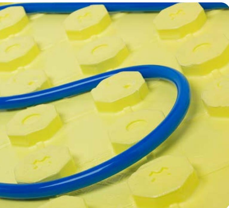
**NEW PLUS** è un sistema di riscaldamento e raffrescamento a pannelli radianti a pavimento di tipo tradizionale, caratterizzato da tubazione ancorata a una base isolante e annegata nel massetto. Contraddistinto da un ingombro complessivo di 7.3 cm (compresi 4 cm di massetto, escluso il rivestimento) è ideale per le nuove costruzioni, per le ristrutturazioni e per tutte le applicazioni dove è necessario ridurre lo spessore occupato dall'impianto radiante.
