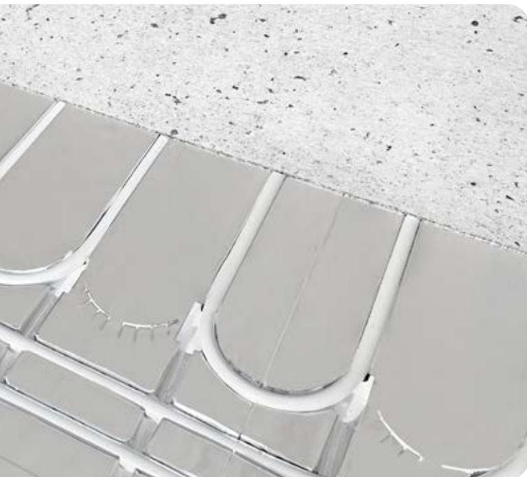
e-DRY TECH è un sistema di riscaldamento e raffreddamento a pavimento a secco, ultraleggero (meno di 6 kg/m<sup>2</sup>) di ridotto spessore (solo 29 mm), ideale in presenza di spazi limitati o dove non è possibile utilizzare massetti. L'assenza del massetto riduce l'ingombro, elimina la necessità della betoniera e consente di realizzare un impianto subito calpestabile e pronto per la posa del rivestimento.
