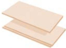
Lastra isolante in polistirene espanso estruso prodotte con gas ecologici, senza CFC e HCFC, conformi al regolamento europeo EC 2037/2000, con proprietà termoplastiche e una struttura a celle chiuse, che conferisce al prodotto eccellenti proprietà termiche e meccaniche. Resistenza alla compressione al 10% di deformazione secondo EN 826: 250 kPa per spessore 20 mm e 300 kPa per spessori da 30 a 80 mm.
