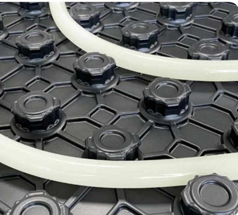
**TF CAM** è un sistema di riscaldamento e raffrescamento a pannelli radianti a pavimento di tipo tradizionale, caratterizzato da tubazione ancorata a una base isolante e annegata nel massetto. Elemento centrale del sistema è il pannello in polistirene espanso prodotto in conformità alla normativa UNI EN 13163 e ai Criteri Ambientali Minimi (CAM).
