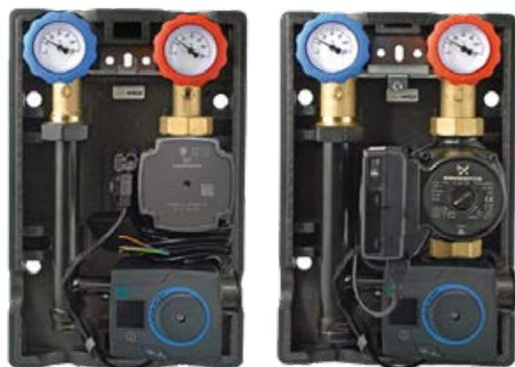
Il gruppo di miscela **GM PF-CF CLIMA** è un dispositivo da centrale termica per la distribuzione del fluido termovettore negli impianti radianti di riscaldamento e raffreddamento a pavimento.
