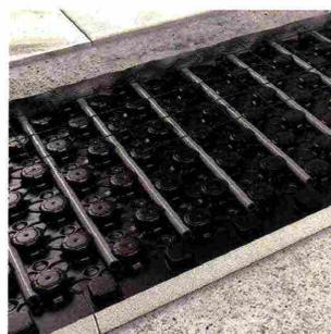
↑ Il pannello **Premium di Viessmann** ([www.viessmann.it](http://www.viessmann.it)) è in polistirene espanso termoformato e isolato, con il lato superiore con pellicola rigida, sagomato a bugne, che **agevola la posa del tubo e ne evita lo schiacciamento**. Ha spessore totale da 32 a 82 mm, adatto anche per le riqualificazioni.
