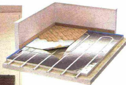
← **Kilma Futura di RBM** ([www.rbm.eu](http://www.rbm.eu)) non necessita di massetto edilizio e, all'accensione, **va a regime in meno di 30 minuti.** Il pannello è in polistirene espanso sinterizzato, con strato isolante e rivestimento superiore in alluminio. La tubatura va fissata in apposite scanalature.
