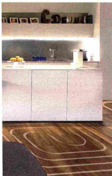
↑ **Neo Super D17 di RDZ** ([www.rdz.it](http://www.rdz.it)) utilizza pannelli bugnati in polistirene sinterizzato con grafite, di spessore di 15 o 34 mm, a elevata resistenza meccanica. I tubi Tech PE-Xa Ø 17 sono in polietilene reticolato ad alta densità con **barriera all'ossigeno, che lo mantiene efficace nel tempo**.
