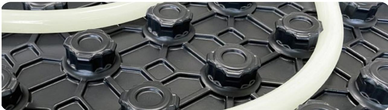
**TF HP CAM** è un sistema di riscaldamento e raffreddamento a pavimento, caratterizzato da tubazioni ancorate a una base isolante e annegate nel massetto. L'elemento centrale dell'impianto è il pannello bugnato in polistirene espanso sinterizzato arricchito con grafite, conforme alla normativa UNI EN 13163 e prodotto secondo i criteri ambientali minimi.
