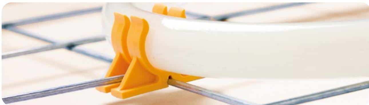
**Rete filo 3** è un sistema di riscaldamento e raffreddamento caratterizzato da tubazioni ancorate a una rete metallica in acciaio zincato con filo 3 mm e maglia di 100x100 mm o 150x150 mm, e annegate nel massetto.
